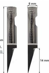
**Description:** Similar to the SR6315 and SR6316 pero con la hoja aún más delgada optimizada para los detalles más finos. Espesor de la hoja 0,25 mm. Una hoja de carburo de tungsteno más delgada que da menos sobrecorte. Excelente hoja para cortar materiales como plástico corrugado y tablero de espuma blanda.
