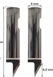
**Description:** Cuchilla de carburo de tungsteno de larga duración para los materiales flexibles más delgados. Para usar en la herramienta RM Knife. Longitud: 40 mm. Base cilíndrica de 8 mm. Espesor de corte máximo de unos 6,5 mm. 30° de sobrecorte. El valor de desfase nominal es 0 mm. **Grueso:** 8 mm.
